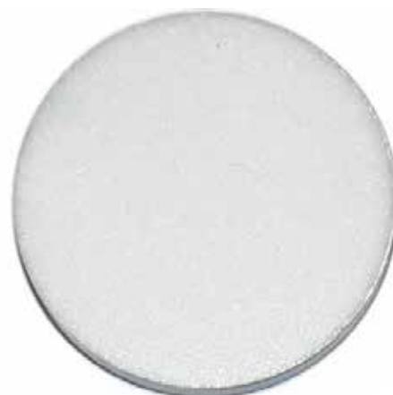
Pastillas producidas por prensado libre
