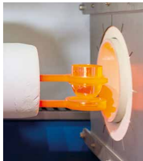
Crisol al rojo y molde de fundición de platino/oro después de la fusión
