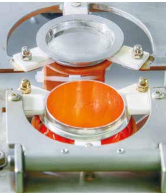
Fusión por inducción con alta frecuencia
