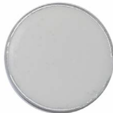
Pastillas producidas por prensado en láminas de aluminio
